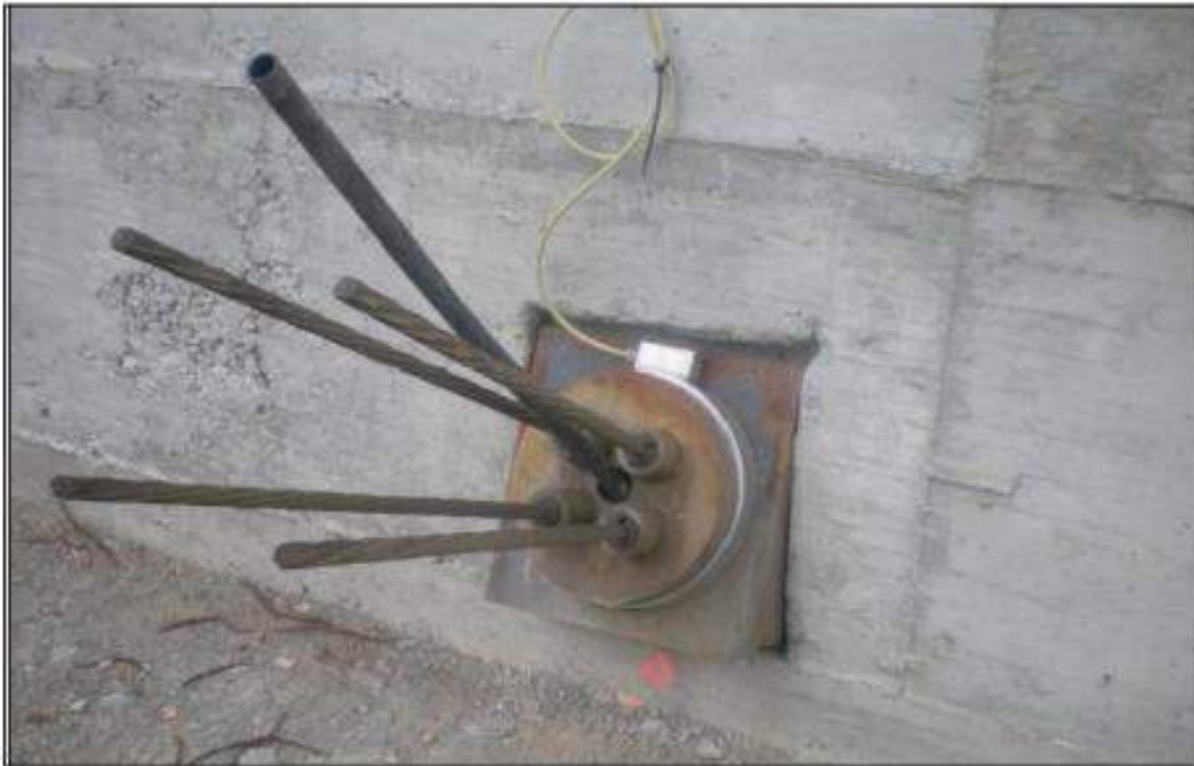
Fig 4.11: Particolare della cella CI dopo l'installazione
